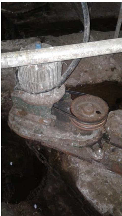
Не ограждена ременная передача системы навозоудаления
