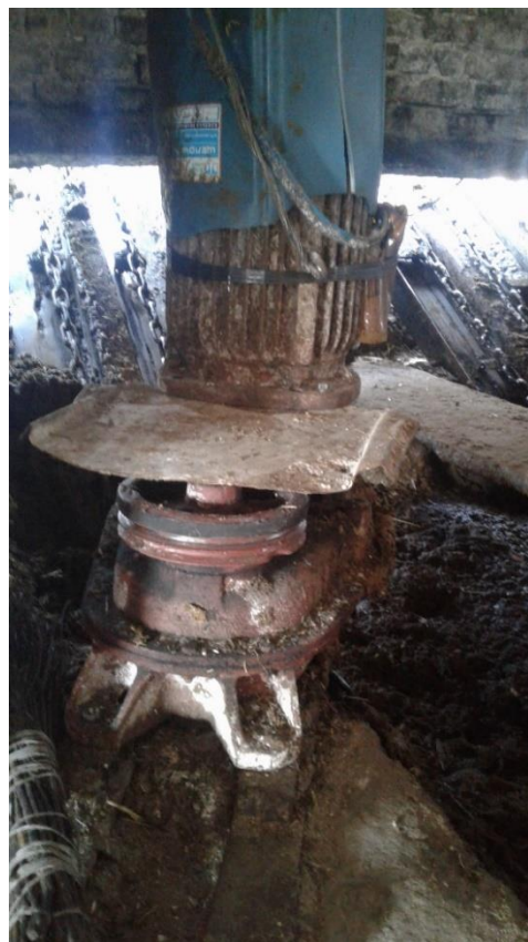
Не ограждена ременная передача системы навозоудаления
