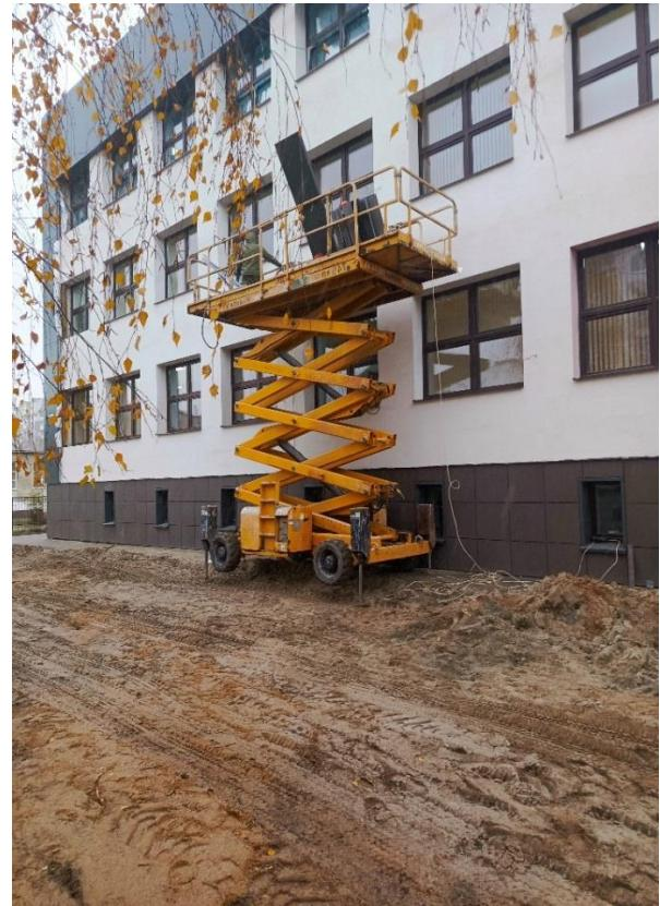
*Мобильные подъемные рабочие платформы допущены к эксплуатации без проведения в установленном порядке технического освидетельствования, на видном месте конструкции не указан регистрационный номер, грузоподъемность, дата следующих технических освидетельствований. Не установлены ограждения и не обозначены в установленном порядке границы опасных зон.*
